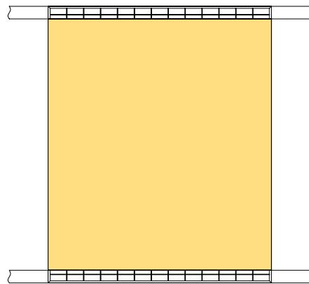
**Lastfall 1:** gleichmäßig verteilte Flächenlast pro MEAMODUL, zwischen den Regaltraversen.
